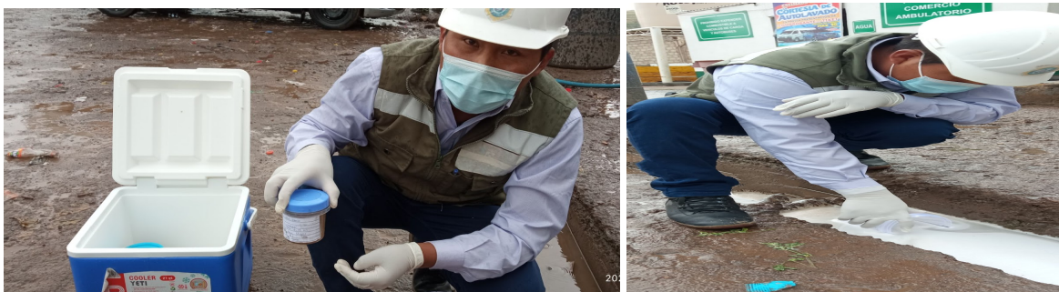
Figura 07 Toma de muestra de agua residual de autolavado “EL CHATÍN”
