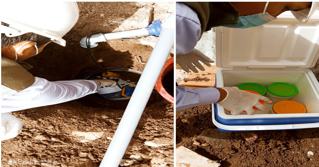
Figura 15 Toma de muestra de agua residual tratada, para analisis fisico-quimico en laboratorio
